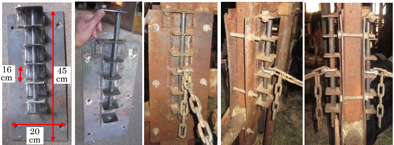
図3 両サイドの支柱に取り付けたチェーン固定用金具 (2020年度、畜産試験場)
