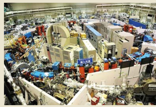
▲極端紫外光研究施設 地上にない光を人工的に作り出し、分子の研究に利用するための電子の加速器（国際的に UVSOR の愛称で知られる）
