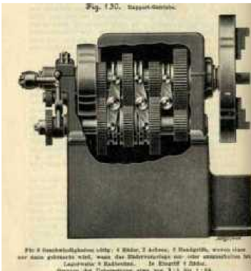
Ruppert-Getriebe, Abbildung aus der Veröffentlichung Friedrich Rupperts: Aufgaben und Fortschritte des deutschen Werkzeugmaschinenbaus, 1907
