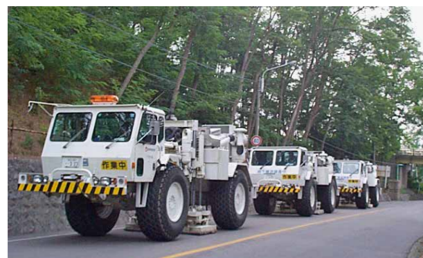
△パイプロサイス車による陸上弾性波探査の様子
