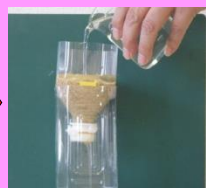
◆ペットボトルを使ったしみ込み実験
