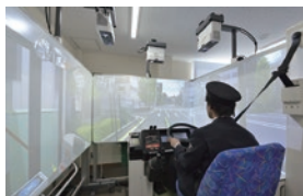
バス運転シミュレーター
