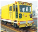
遠隔制御車「701B」 道床砕石や残土を積載し、低床トロリの端部で活躍します。
