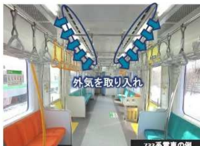
733系電車の例 空調設備による車内換気(通勤列車)
