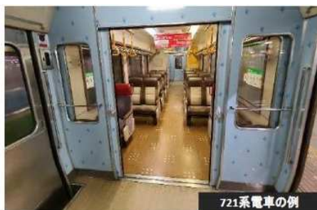
721系電車の例 客室内仕切り戸を開放し車内換気
