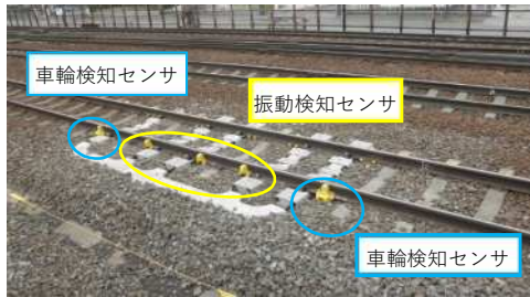
車輪検知センサ・振動検知センサ
