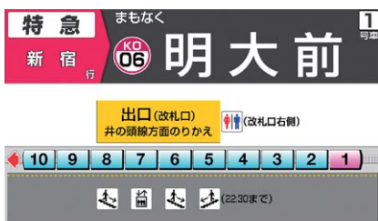
液晶画面を用いた車内案内表示器
