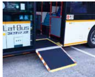
▲車いすスロープ
