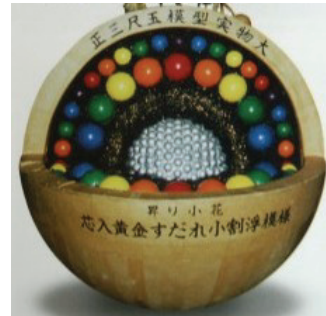
図5. 正三尺玉の実物大模型（直径90cm）[3]
