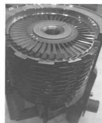
上の写真はターボ分子ポンプの断面です。このポンプは、見かけは航空機用のターボ・エンジンによく似ています。高速で回転する円筒の周囲に取り付けた、軸に対して傾いている幅の狭い多数の羽がある動翼と、動翼に対して逆に傾けて取り付けた固定翼である静翼を交互に並べて軸方向に気体を送るポンプです。
