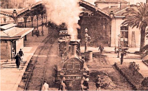
Un train rapide à l'arrêt en gare de Cannes dans les années 1880. La locomotive est une petite machine à deux essieux moteurs, de 1879, série 111-400, assurant l'ensemble des trains prestigieux du PLM à la Belle époque. © Collection Lamming
