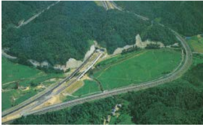
*16 [名神高速道路 線形が改良された今須地区] (『名神高速道路の維持管理-20年のあゆみ-』・日本道路公団・昭和60年10月)
