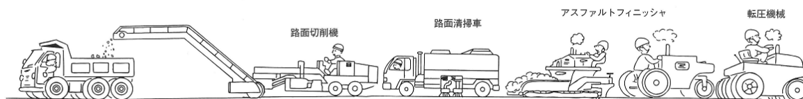
図 4.3.1 切削オーバーレイ (出典：『写真でみる高速道路の舗装』(財)高速道路技術センター・平成 15 年 3 月)
