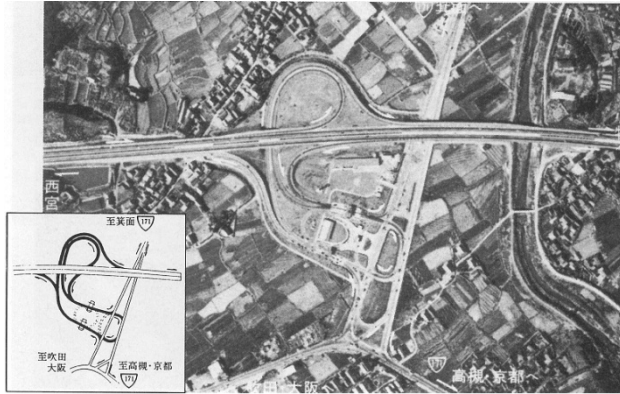
*44 [トランペット型インターチェンジ] (『高速道路はじめて事典』・(財) 高速道路技術センター・平成9年9月)
