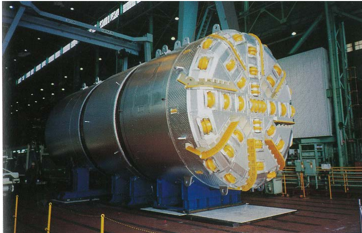
*7 〔新東名高速道路で使用された TBM〕 (『大断面トンネルに挑む!』・日本道路公団静岡建設局・平成 13 年 3 月)
