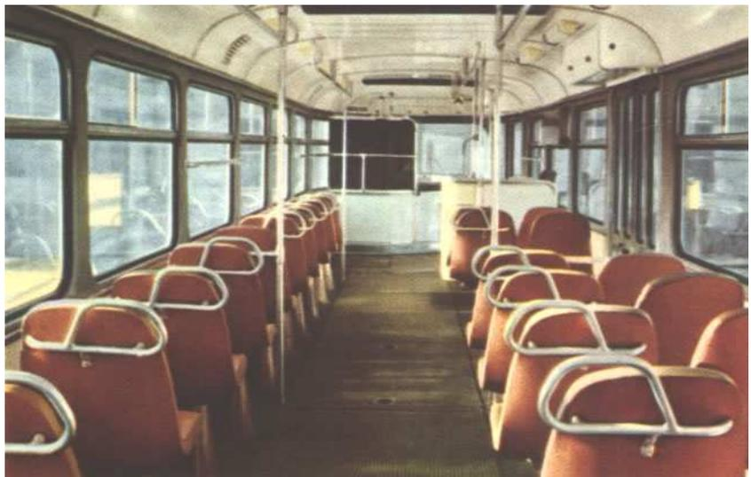
nung in mehreren Reihen oder nach dem Wunsch des Bestellers angebracht. Die Fenster, an denen sich keine Sitze befinden, werden durch horizontale Handleisten geschützt, die zugleich auch als Haltestangen dienen. An den Türen sind senkrechte Haltestangen angeordnet.
