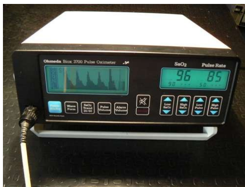
Fig. 2.8 Ohmeda BiOXによる脈波表示機能を付加したBiox3700。
