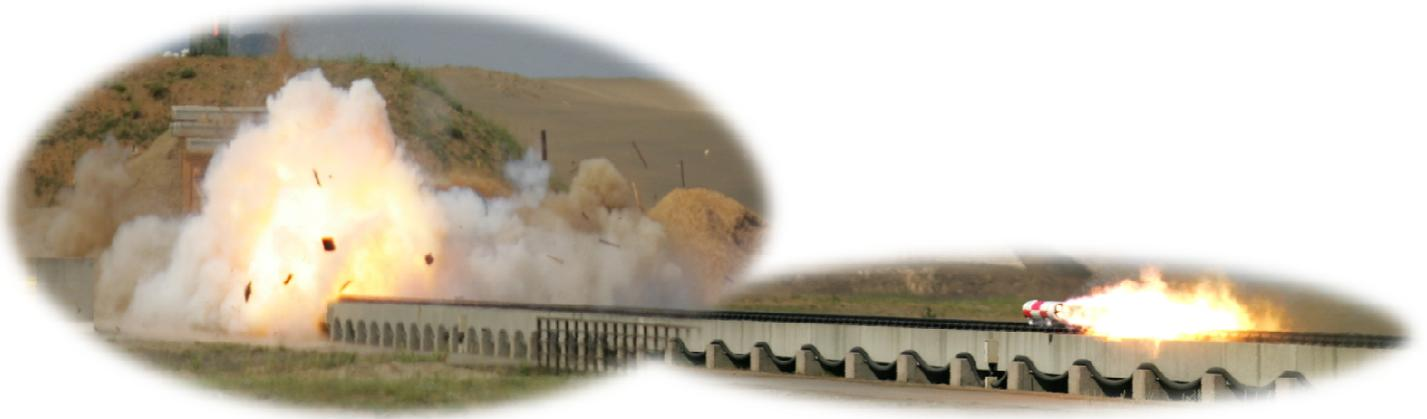
長さ360mのレールランチャー上をロケットモータなどの推進装置と弾頭・信管を組み合わせ、滑走させ、各種標的に対して命中させる。
