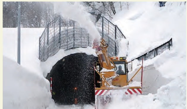
ロータリー除雪車による除雪状況
