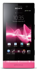
「Xperia U」 約3.5型ディスプレイのコンパクトモデル。下部の透明部分「Floating Prism」がホワイトに加え、オレンジ、ブルー、グリーンなどカラフルに点灯。
