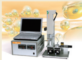
NS-S2000 型粉体層せん断力測定装置
