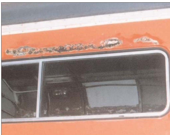
Ernstige roestschade aan de MBD 17.00.
