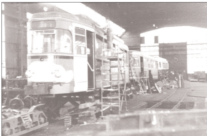
De ombouw en het schilderen tot het 'Sperwer'-stel in de Centrale Werkplaats van de RTM aan de Kromme Zandweg in Rotterdam-Zuid. Gezien de opstelling moet het eerste rijtuig - nog gedeeltelijk in DB-kleur - de 17.01 zijn, het middenrijtuig staat nog in de menie en het laatste rijtuig is al in de RTM-kleuren geschilderd. 27 juni 1963. Foto: Theo Barten.
