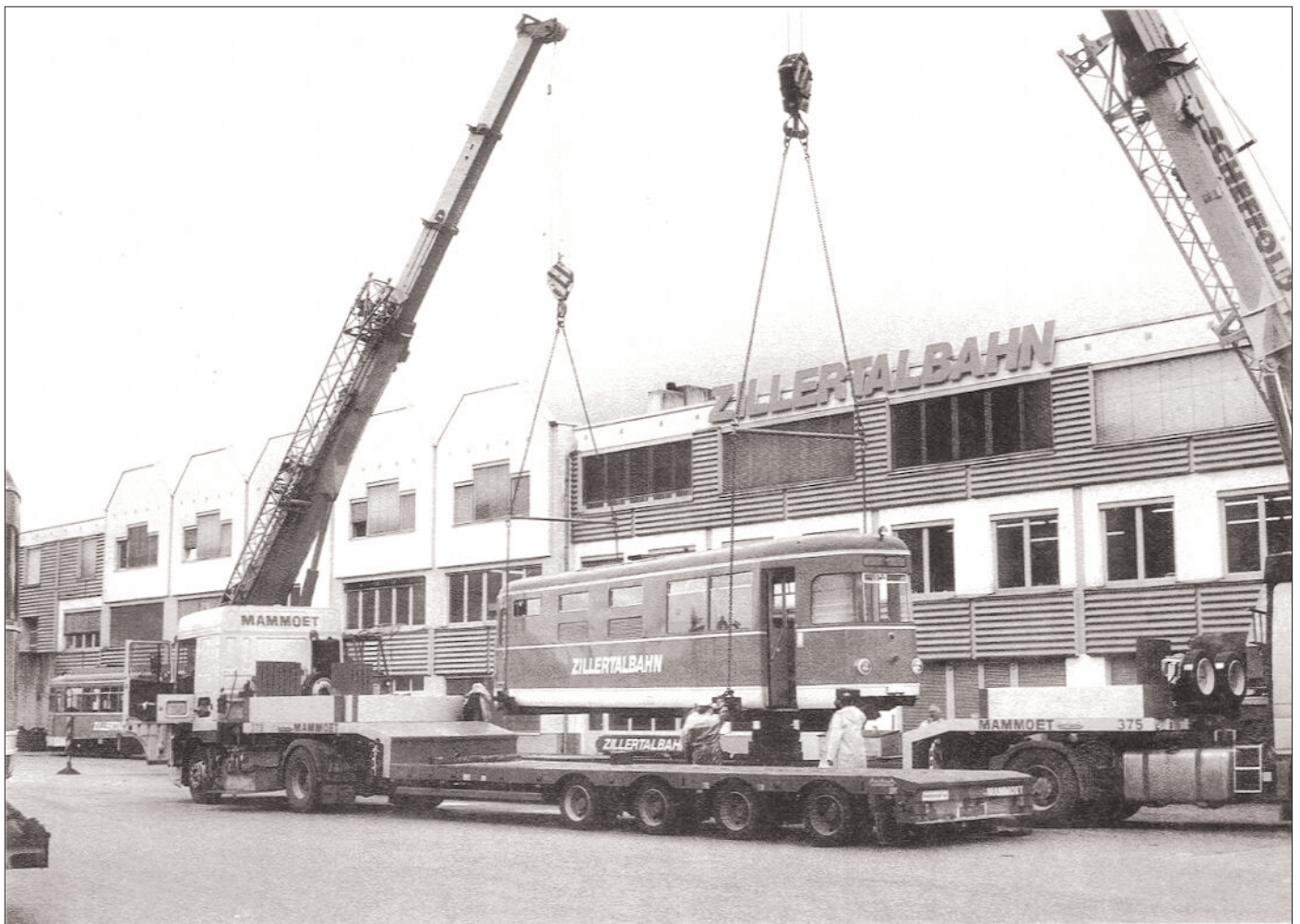
De MBD 17.00 hangt nu in de takels en wordt naar de oplegger gemanoeuvreerd. Jenbach, 6 oktober 1999.
