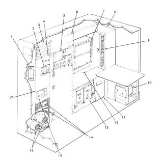
1 - REMOTE FIRING BOX 2 - AZIMUTH LAYING CONTROL BOX 3 - AIR DUCT REGISTER 4 - PHONE CONTROL PANEL ASSEMBLY 5 - ADAPTER 6 - STORAGE CABINET
