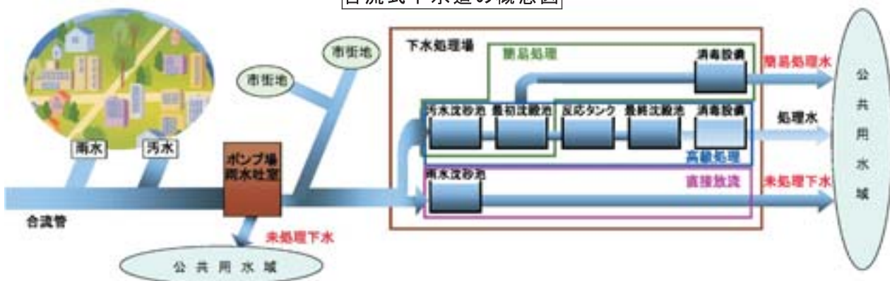
合流式下水道の概念図
