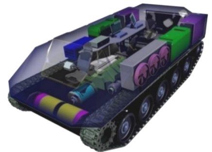
ハイブリッド動カシステムの搭載構想図
