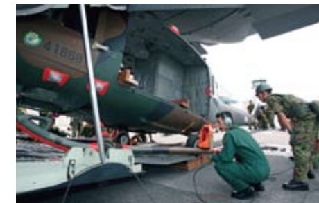
専用の車輪を装着し、C-130キャビン内へ誘導し収容する隊員
