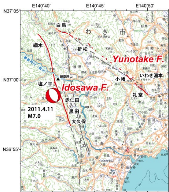
図2 2011年4月11日の福島県浜通りの地震に伴って出現した地表地震断層の分布。灰色の線は既存の活断層図（活断層研究会編，1991；中田・今泉編，2002）に示されている活断層。震源メカニズム解とその位置は、気象庁が公表している発震機構のCMT解に基づく。
