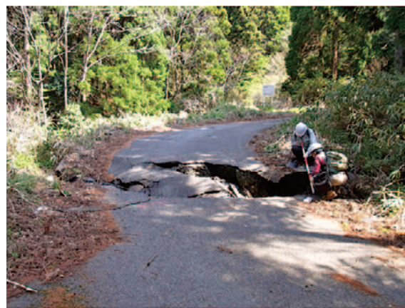
写真4 湯ノ岳断層における地表地震断層の測量作業 (いわき市常磐藤原町小幡地区)。
