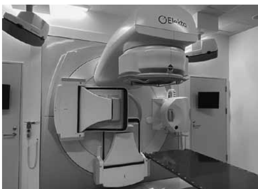
新しい放射線治療装置 (Elekta Versa HD) 一番大きいのが高エネルギー放射線の 照射ヘッド、その左右には診断用エッ クス線発生装置とフラットパネルがあ り、回転してCT撮影が可能
