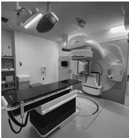
新しい放射線治療装置 (Elekta Versa HD) 天井に設置されているのが体表面追跡カメラと 超音波走査プローブの位置検出カメラ
