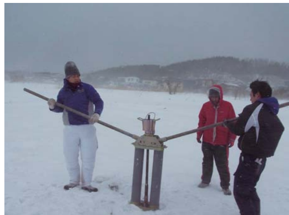
写真4 鳴沢地区におけるボーリング調査
