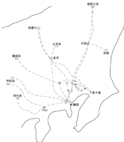
図 2.3 終戦直後(1955年)の東京電力の電力系統 (154kVと66kV) □は発電所
