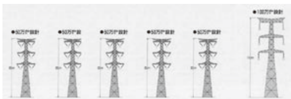
図 6.1 50 万ボルトと 100 万ボルト送電線の比較
