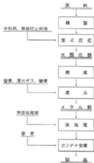
図3.19 メタル磁性体の製造プロセス [21]
