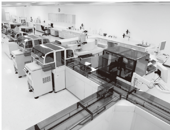
図 9.3 検体搬送システムでつながった臨床検査機器群 15) (シーメンスヘルスケア・ダイアグノスティックス (株) のご厚意により掲載)
