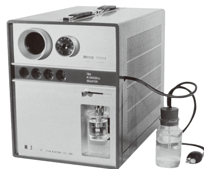
図 3.16 国産初の半自動血球計数装置「CC-1001」 （シスメックス社（当時：東亜特殊電機株）のご厚意により掲載）
