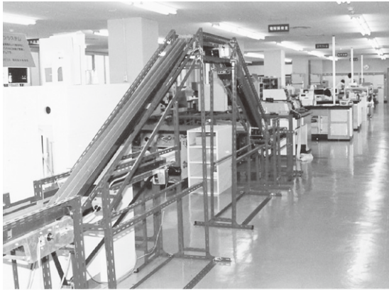
図 9.2 高知医大検査部自製の世界初の検体搬送システム (高知大学医学部附属病院検査部のご厚意により掲載)
