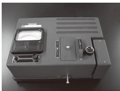
図3.32 昭和36年(1961年)日立製作所製の光電比色計 82) (信州大学自然科学館のご厚意により掲載)
