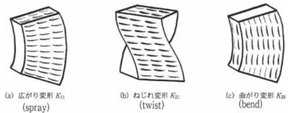
図 2.21 ネマティック液晶物質がしめす3つの分子配向変形と対応する3つの弾性定数 44)
