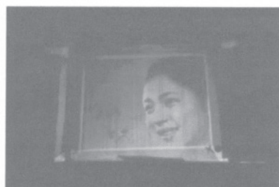
(b) 独自テーマとして試作した階調付 a-Si-TFT3型248x204ドットマトリクスLCD (1983年6月)
