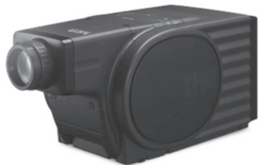
図 7.3 3板式液晶プロジェクター XV-100Z 3型a-Si-TFT-LCD 384x240x3ドット 1998年6月 メタルハライドランプ採用
