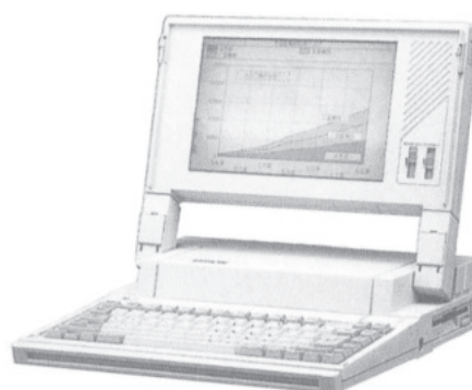
図 3.25 ラップトップ PC EPSON PC-286L 640 \times 400 NTN 液晶 (光学補償セル方式) 32) 1987 年 11 月発売
