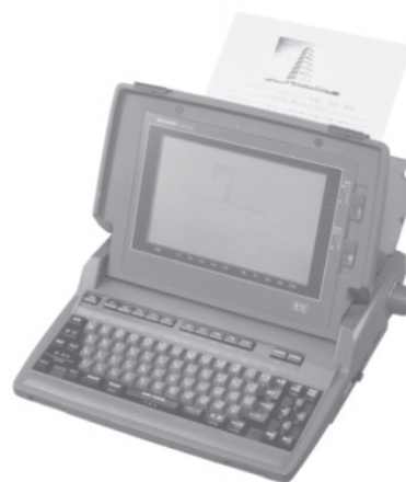
図 3.26 ワープロ シャープ WD-A330 1989 年 7 月発売 640 \times 400 ドット TSTN ハイコントラスト白黒液晶 (バックライト付き)
