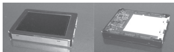
図 7.5 車載用 5.7 型 TFT 液晶モジュール (バックライト内蔵) 1) 720×240ドット 1990年
