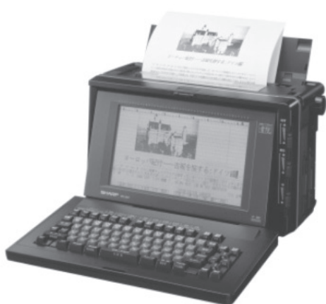
図 3.24 ワープロ シャープ WD-820 1987 年 9 月発売 720 \times 400 ドット DSTN 液晶 (光学補償セル方式)
