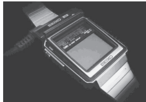
図 4.15 Si ウェハを用いた液晶テレビウォッチ 1982 年 12 月発売 1.2 型 152 x 210 ドット 15)
