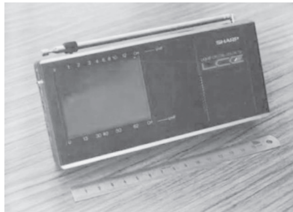
図 5.29 A190PT 試作 TV a-Si-TFT 3.2 型 240Vx368Hドット カラーフィルター：Δ配列 1985年9月 39)
