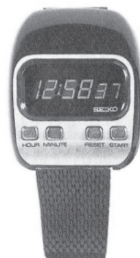
図 2.52 DSM液晶表示式デジタル腕時計プロトタイプ (諏訪精工舎 1971年12月) 76)
