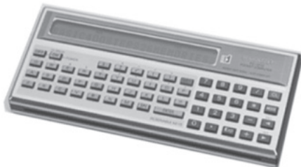
図 3.4 ポケットコンピュータ：PC1210 1980年3月発売 5 × 7 ドット 24桁 (144 × 8 ドット)
