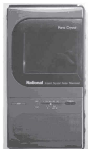
図 5.16 世界初 a-Si-TFT フルカラー液晶テレビ 松下 TR-3LT1 の外観 (a) 1986 年 7 月発売 25) 3 型 a-Si-TFT LCD 372 × 240 ドット
