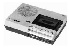
図 6.11 ソニー TC-1160 (1968 年)<sup>11)</sup> 初のエレクトレットコンデンサーマイクロホン内蔵機
