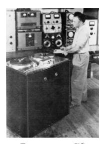
図 4.2 AMPEX200 型 2)
