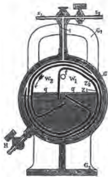
図 6.34 ゲーデの水銀回転ポンプ 9)
