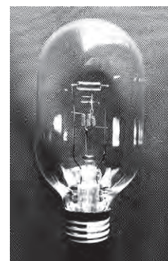
図 3.33 最初の二重コイル電球のレプリカ
