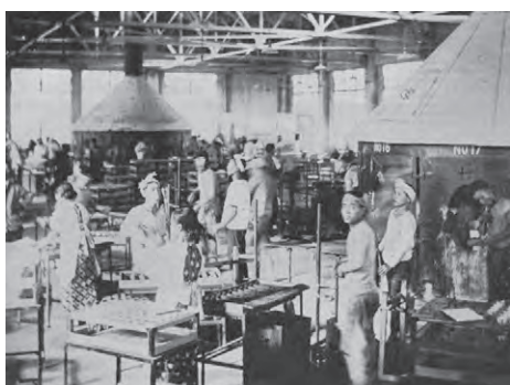
図 6.13 ガラスバルブの手吹き作業現場(小倉工場) 4)
