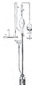
図 6.27 スインバーン式ポンプ 8)
