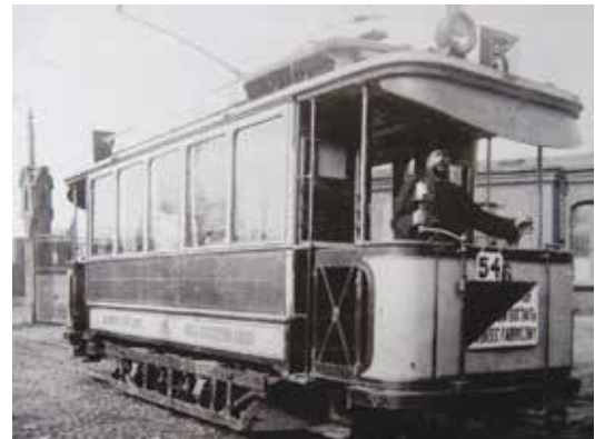
Rys. 32. Wagon silnikowy Herbrand U – 107 C. Łódź, 1915 r. [31]
