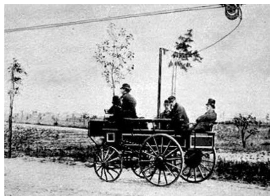
Rys. 17. Elektromote – pierwszy trolejbus Siemens [22]
