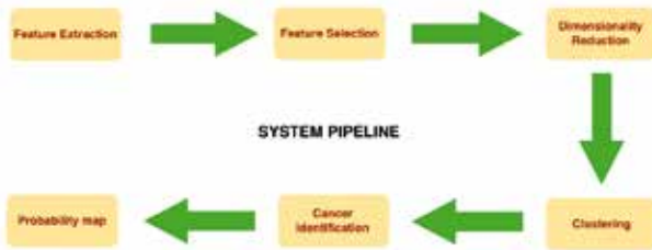
Rys. 4. Schemat podstawowych poziomów systemu CAD
