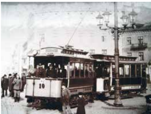
Rys. 30. Wagon silnikowy Herbrand VNB-125 z doczepką, 1898 r. [31]
