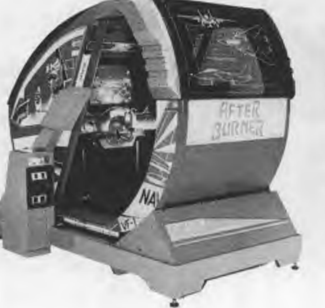
アフターバーナー (ダブルクレイドルタイプ) 同社体感ゲーム第6弾。TV空中戦。ゲーム展開に合わせコックピットが前後左右に揺動。OP価格178万円。【セガ社】No314
