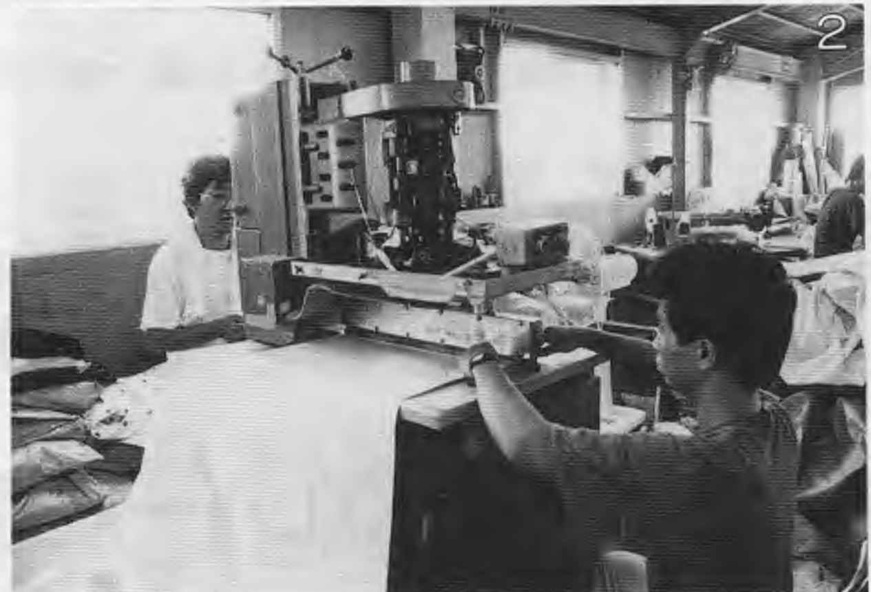
「ファファ」の加工工程 ①裁断：設計図をもとに生地を線引きし、裁断機で裁断する②溶着：生地の塩ビを溶かしてつなぎ合わせる（機械は高周波ウェルダー）③長い部分をライスターという機械で溶着しているようす。生地は床下からエアで吸着して固定している④縫製：ミシンで縫製する。右手前の大きなテーブルは回転して縫製を補助する⑤組み立て：部品にエアを送って、漏れなどのチェックをしているところ。手前にあるのが本体
