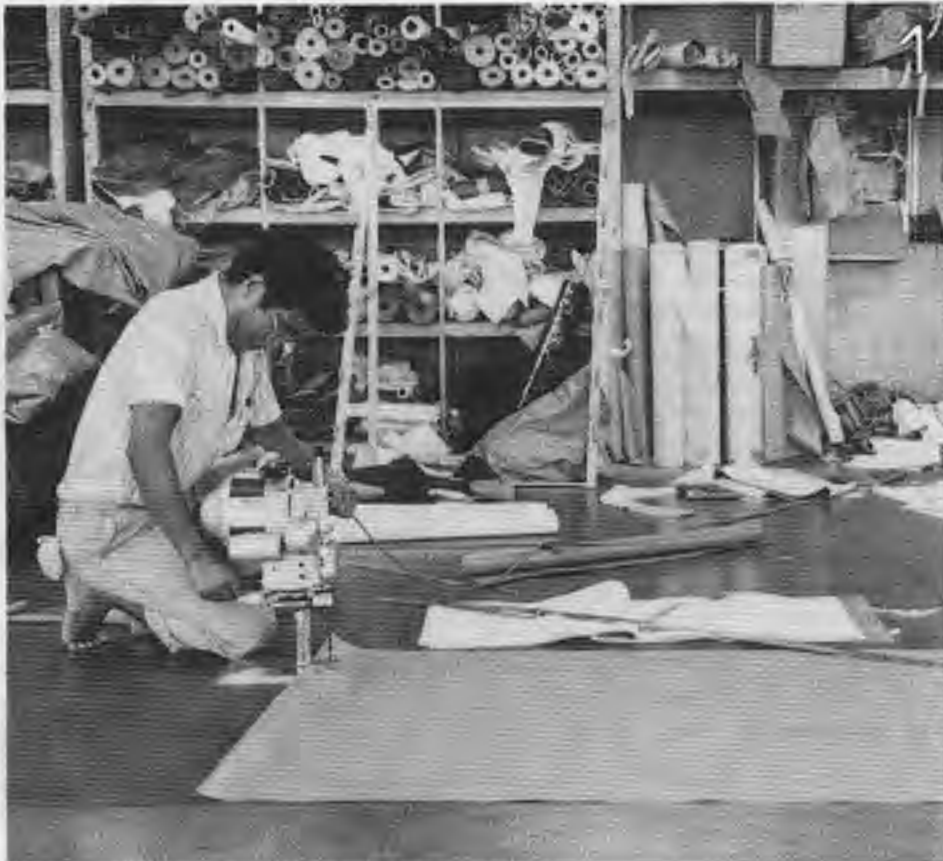
「ファファ」の加工工程 ①裁断：設計図をもとに生地を線引きし、裁断機で裁断する②溶着：生地の塩ビを溶かしてつなぎ合わせる（機械は高周波ウェルダー）③長い部分をライスターという機械で溶着しているようす。生地は床下からエアで吸着して固定している④縫製：ミシンで縫製する。右手前の大きなテーブルは回転して縫製を補助する⑤組み立て：部品にエアを送って、漏れなどのチェックをしているところ。手前にあるのが本体
