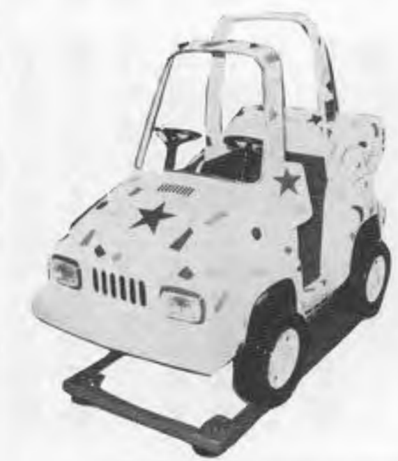
ミルクカー・スペシャルタイプ ジープをデザイン化した定置乗物機でローリングとピッチングを繰り返す。助手席にもハンドルが付いている。定価53万円。【真砂工業】No262
