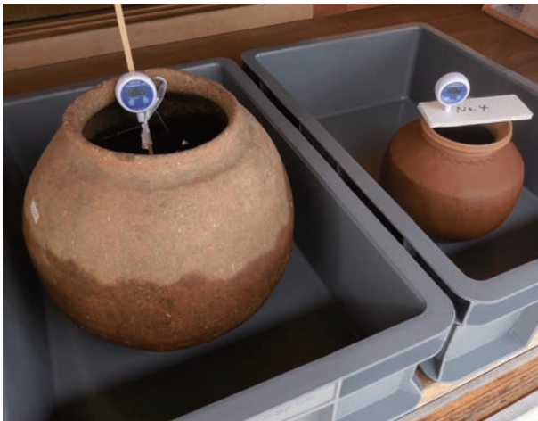
写真 16 パナリ焼（左）とカンボジア土器（右） に見られた水の浸み出し
