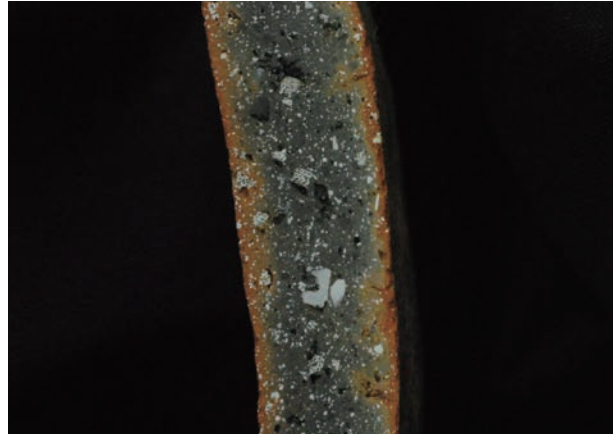
写真 3 パナリ焼の断面写真 ポーラスなサンゴ片が多く見られる。
