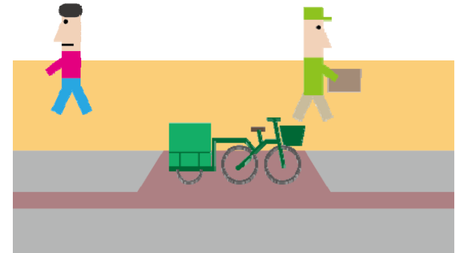
自転車走行空間と一体の自転車荷捌きスペース
