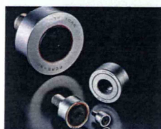
カムフォロア・ローラフォロア 外輪が厚肉で、クラウニングを施されたころは動滑りが低減され、クランプ力
