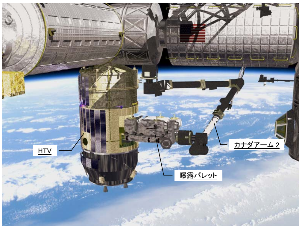
図 8.2.4-1 曝露パレットの取出しイメージ
