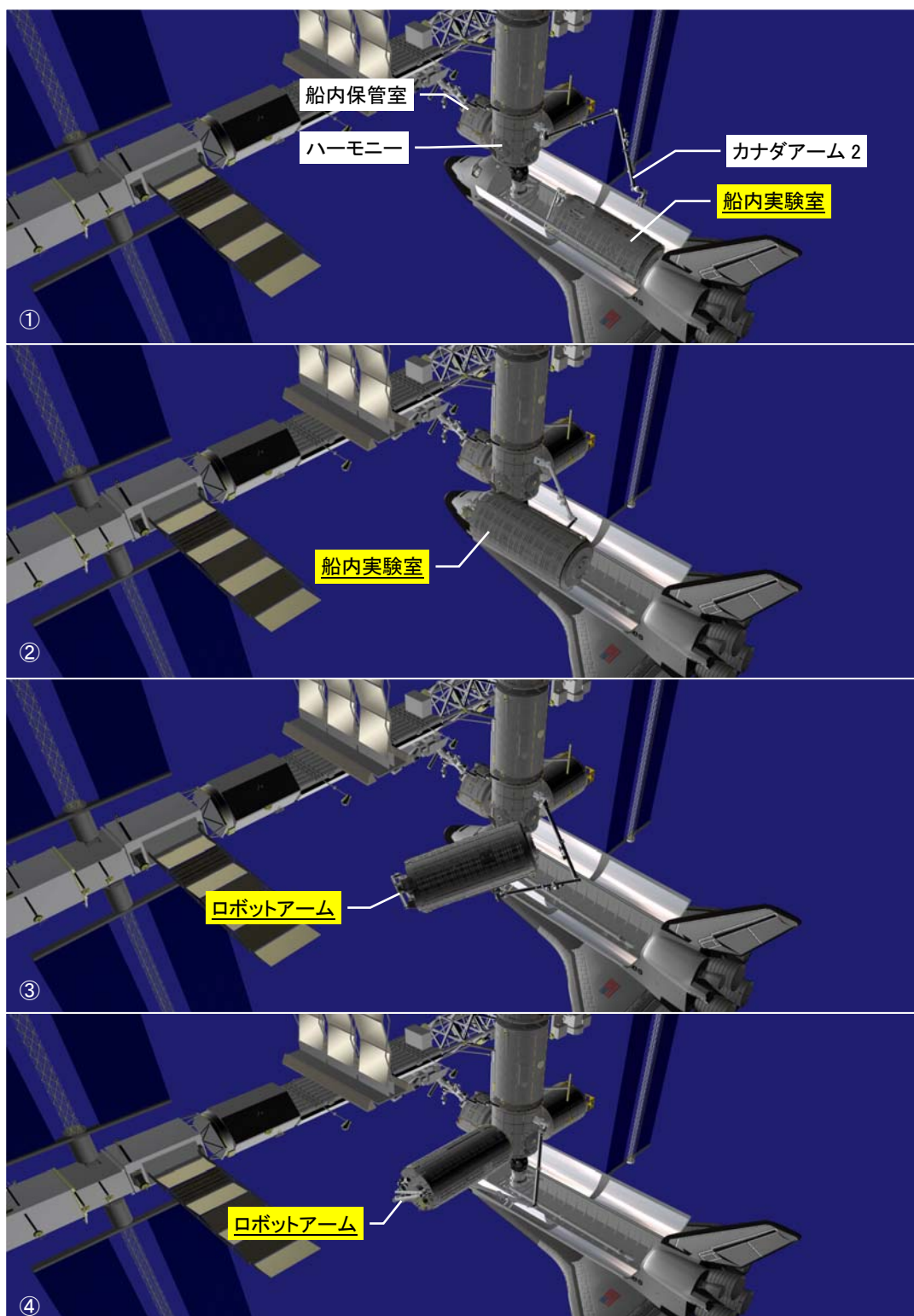
図 5.2.2-3 船内実験室のISSへの取付け手順
