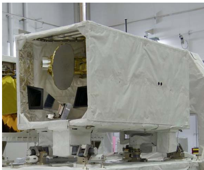
図 3.3.2-1 HTV 曝露パレットに設置された SMILES
