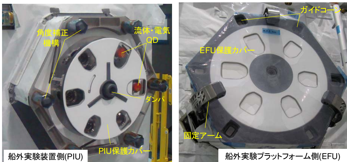
図 3.1.1-4 装置交換機構(EEU)概要
