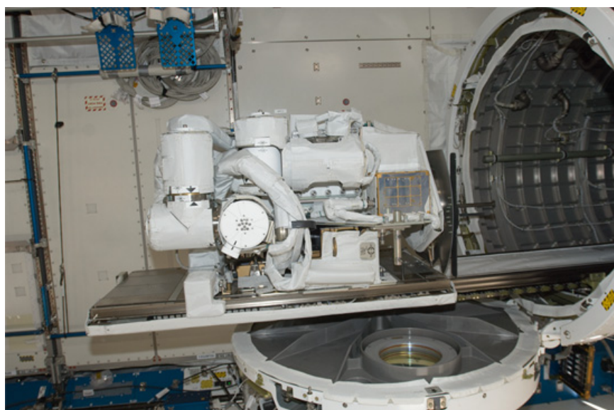
図 2.3.2-1 きぼうエアロック 2010年1月6日撮影 (船内実験室へテーブルがスライドしている状態。天頂方向から撮影)
