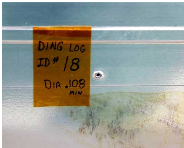
図2.1.6-1 スペースシャトルアトランティスのペイロードベイドアから2006年に 見つかったデブリ痕(直径およそ2.5cm、深さ3.8cm)
