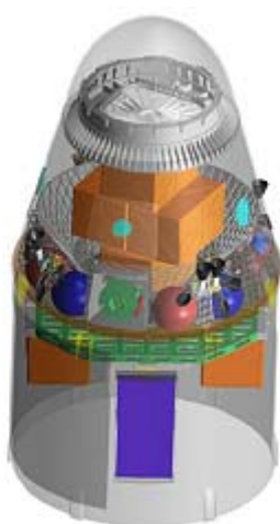
図 3.2.1-3 ドラゴン宇宙船貨物コンフィギュレーション (Space X社ホームページより)
