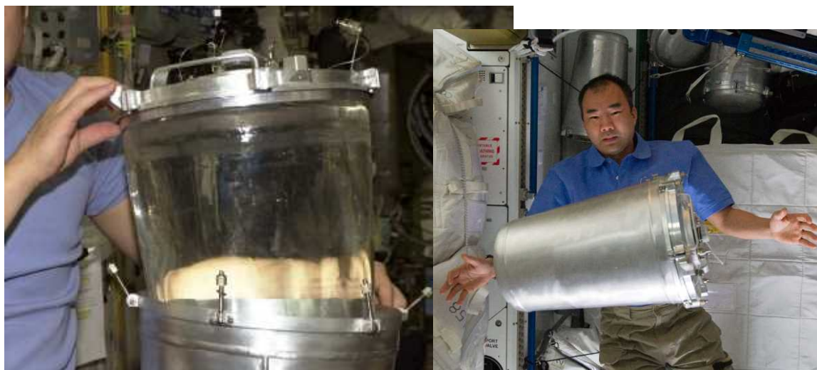
図4.1-5 ロシアの水容器(EDVタンク) (ビニールのような容器を金属容器で囲ったもの)
