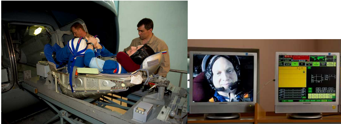
図 5.2-3 帰還直後に遠心加速器に搭乗して操縦試験を行う様子 (GCTC)
