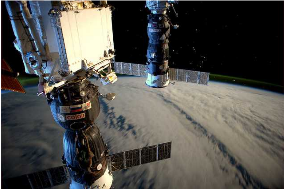
図3.4-4 MRM1にドッキングしたソユーズ宇宙船(29S) (ESA/NASA) 後方はプログレスM-12M(46P)補給船
