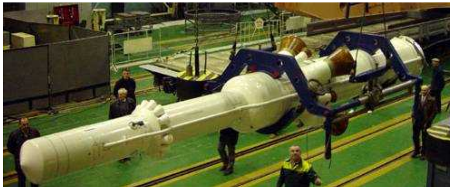
図2.7-1 ソユーズロケット先端に装着される緊急脱出用ロケット(RSCエネルギー社)
