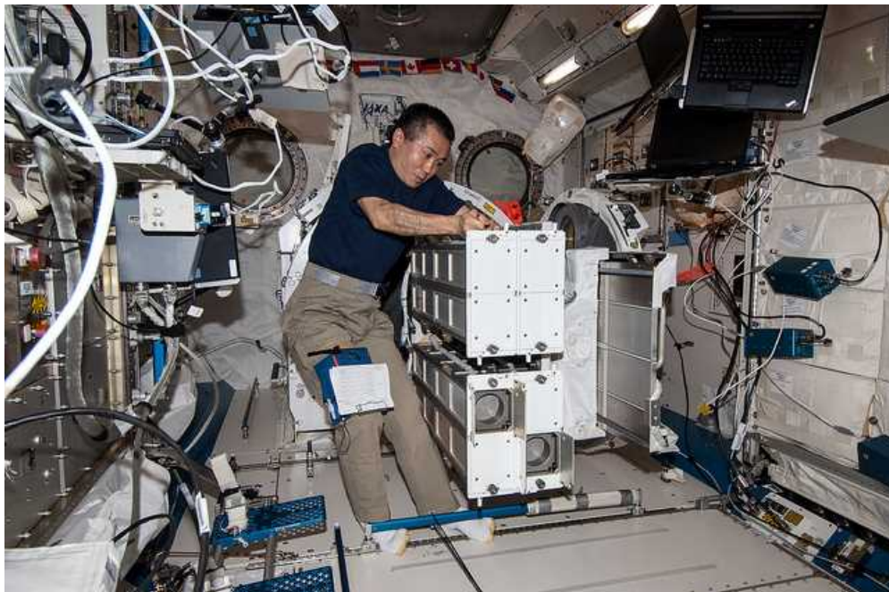
図 4.1.1-25 NanoRacks 社の CubeSat 放出機構を設置する若田宇宙飛行士 これを使えば、3U サイズの CubeSat が 16 機放出できます。
