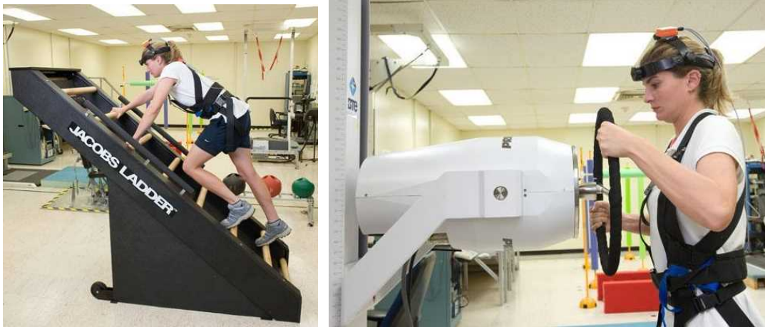
図5.2-5 梯子の昇降能力を試す試験、トルクをかけて回転させる試験の例(NASA)
