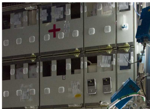
図3.3-8 デスティニー内のクルー健康管理システムラック(CHeCS2ラック)
