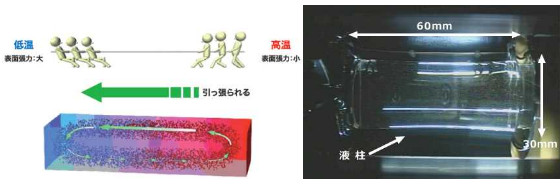
図4.1.1-3 マランゴニ対流の原理(左)と軌道上実験で作られた60mmの液柱(右) [RYUTAIラックの流体物理実験装置を使用] (JAXA)
