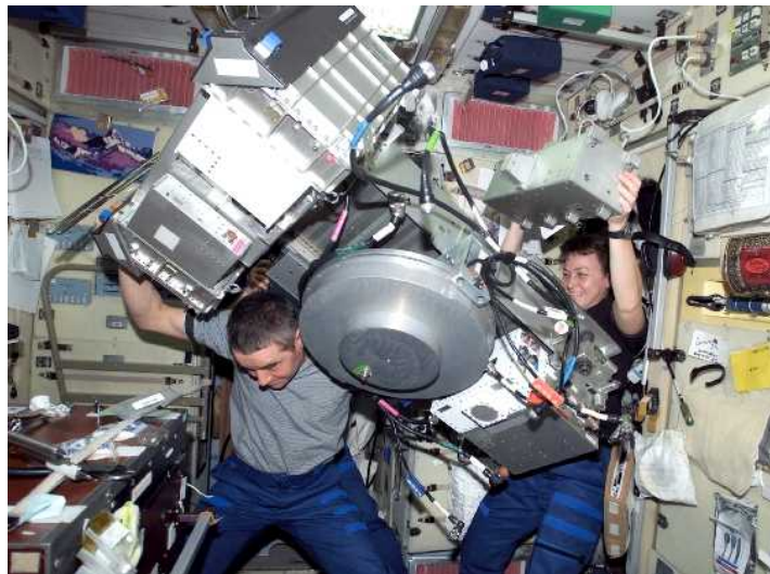
図3.4-1 TVISの修理(床下の機器を取り出した状態:2002年10月)
