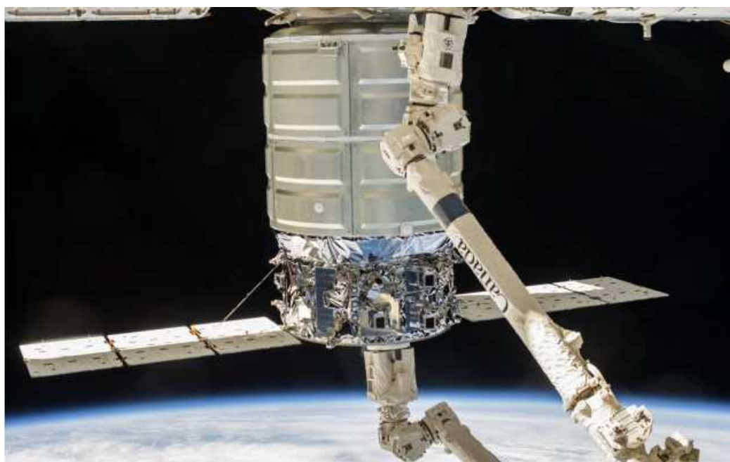
図4.3-8 ロボットアームで把持されたシグナス補給船実証機 (NASA/OSC社)
