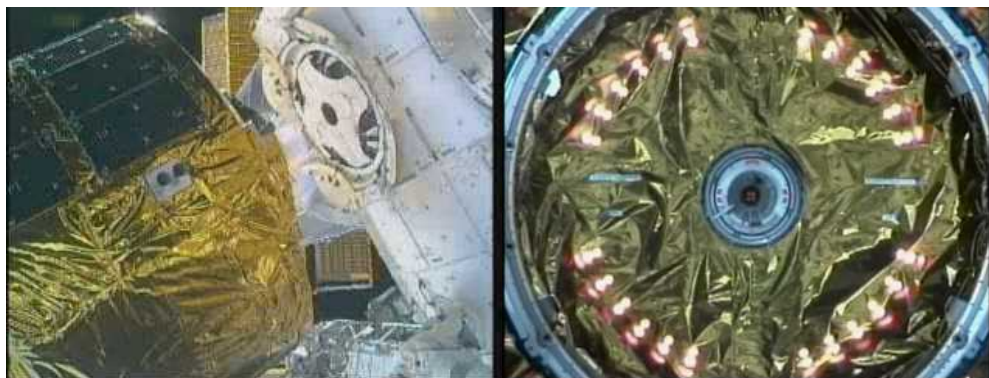
図4.3-6 「こうのとりの」到着時の共通結合機構の位置調整作業 (右は、ハーモニーの窓に位置決め用に設置するCBCS (Centerline Berthing Camera System)から撮影した映像。ドラゴンとシグナスも同様の作業を行います。)
