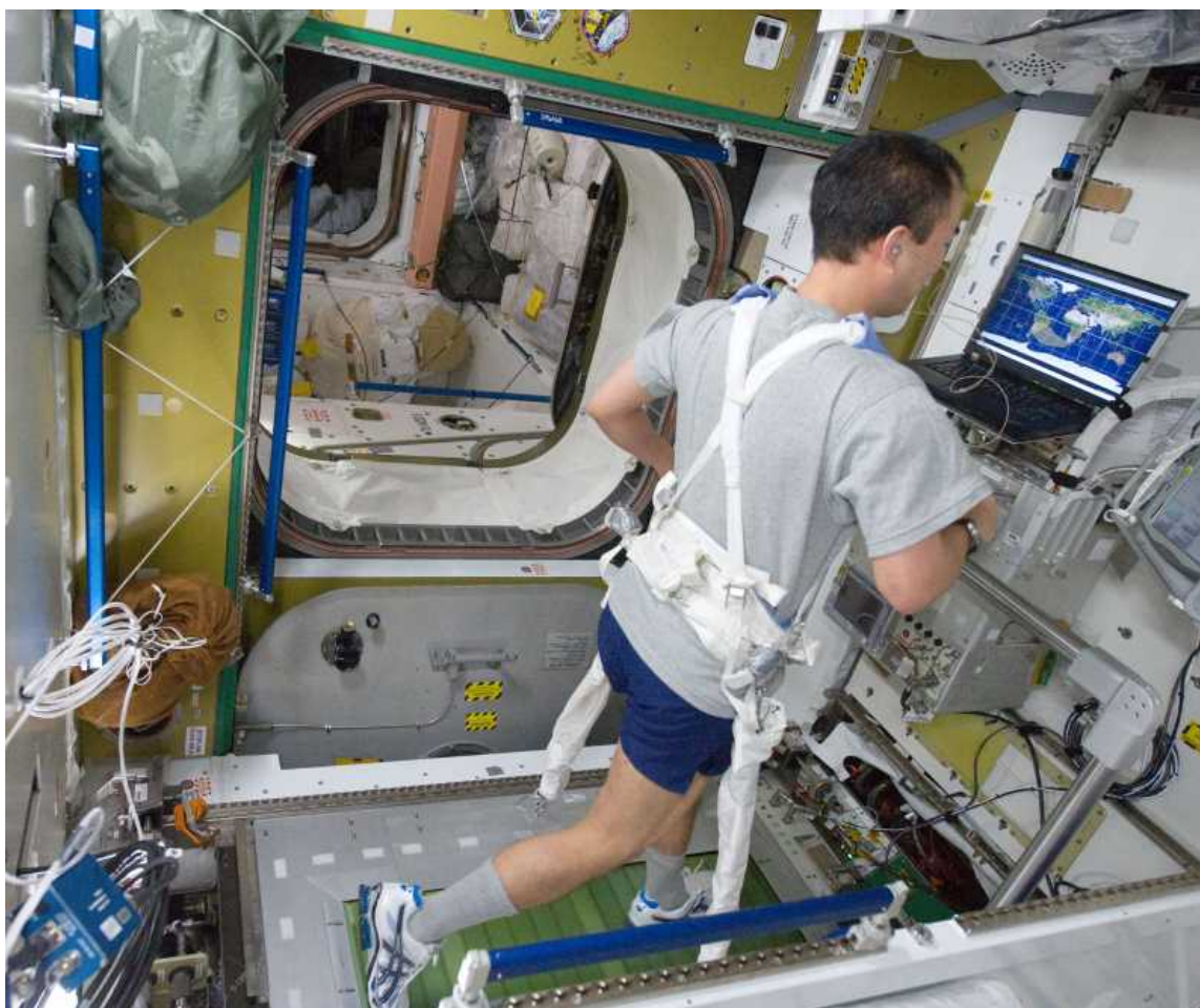
図3.3-2 ノード3内に設置された「COLBERT(コルベア)」を使ってのエクササイズ (※ゴム製のひもで体をトレッドミルに押しつけます)
