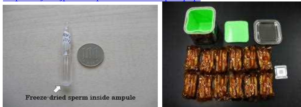
図4.1.1-7 宇宙実験でマウスの精子を保存するのに使用するアンプル。アンプルは右の写真のようにカプトンテープで保護してケースに収納します。(「このとり」4号機で運搬) (JAXA)
