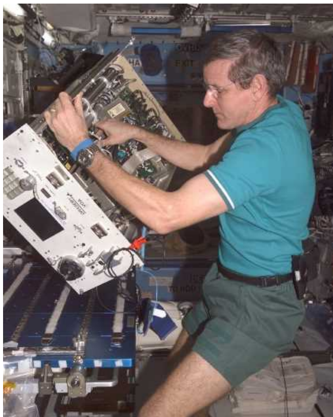
図3.4-5 故障した装置(揮発性有機物分析器(VOA))の修理
