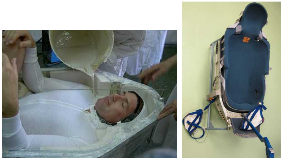
図2.9-2 (左)シートライナーを石膏で型とりする様子 (ESA) (右)座席にシートライナーを装着した状態(カナダ人宇宙飛行士Chris HadfieldのTwitterより)
