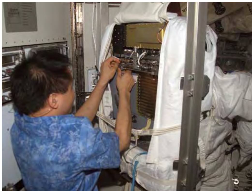
図3.3.4-16 米国の宇宙服の背中の機器のメンテナンス(定期保全)
