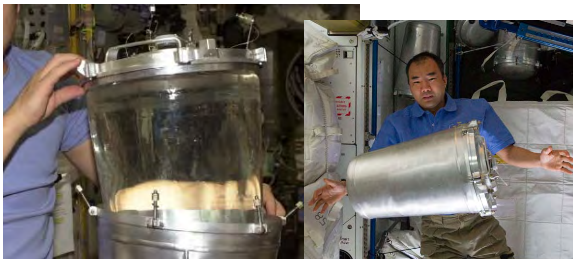
図3.4.1-5 ロシアの水容器(EDVタンク) (ビニールのような容器を金属容器で囲ったもの)
