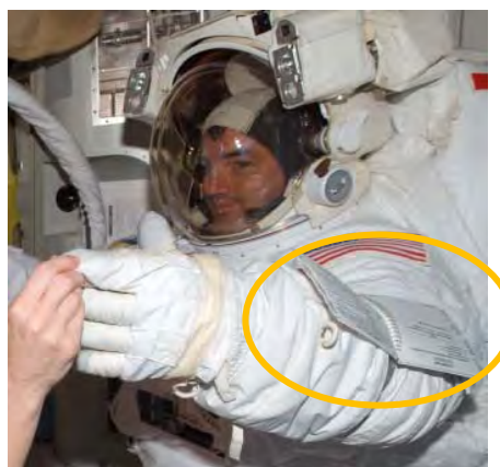
図4.2-25 EVAカフチェックリストの装着状況(NASA)
