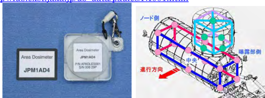
図1.4.1.1-15 AreaPADLESと設置位置
