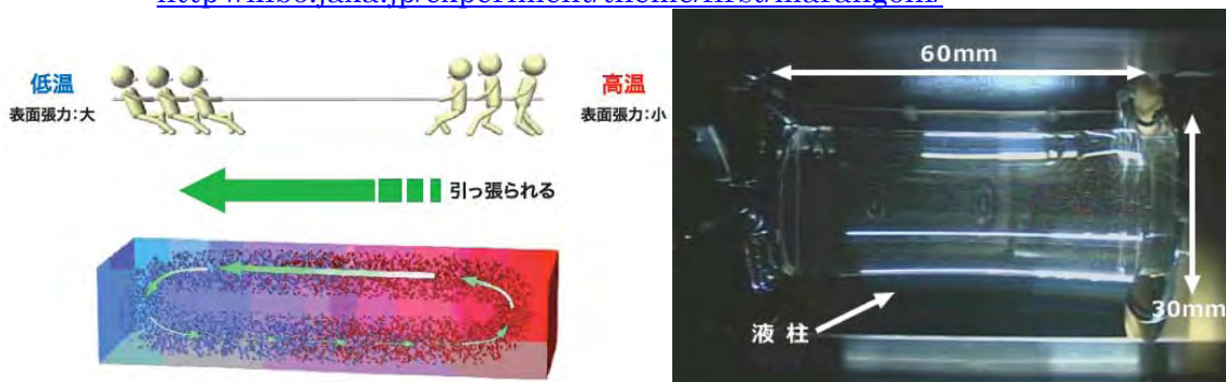
図1.4.1.1-1 マランゴニ対流の原理(左)と軌道上実験で作られた60mmの液柱(右)
