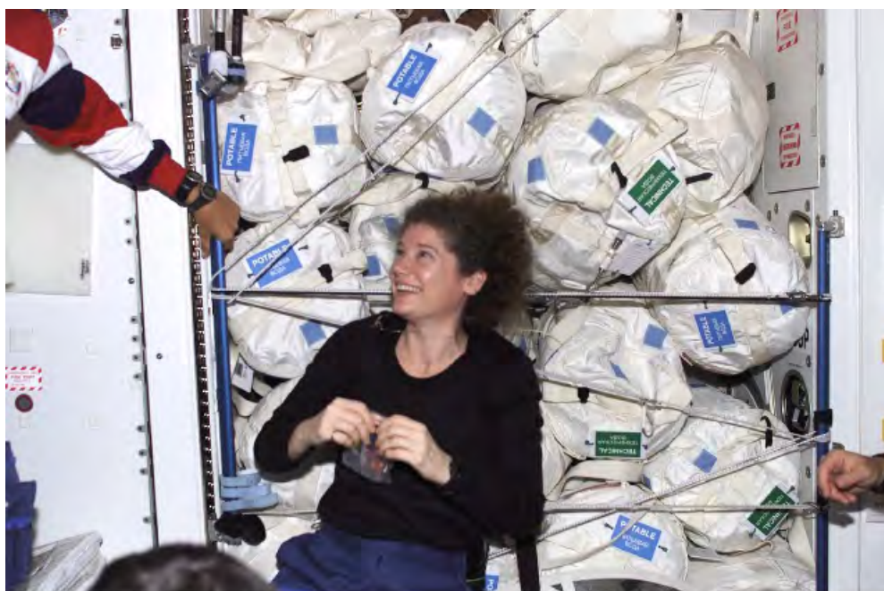
図3.4.1-6 米国の水容器(CWC) (表面が布地のソフトタイプの容器)
