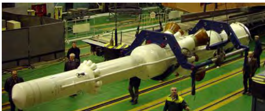
図2.1.6-5 ソユーズロケット先端に装着される緊急脱出用ロケット(RSCエネルギー社)
