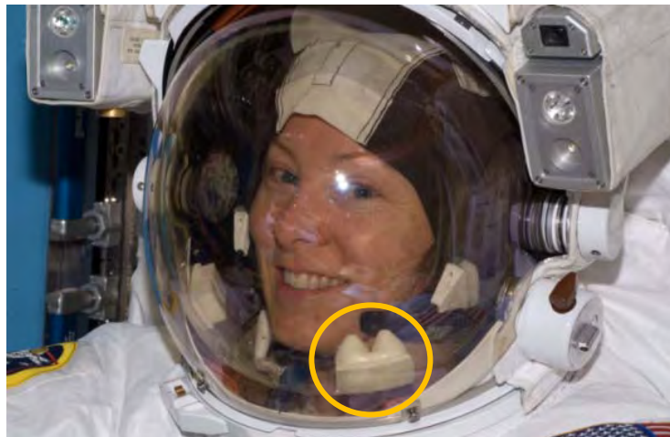
図4.2-31 耳抜き用のバルサラバ・デバイス (NASA)
