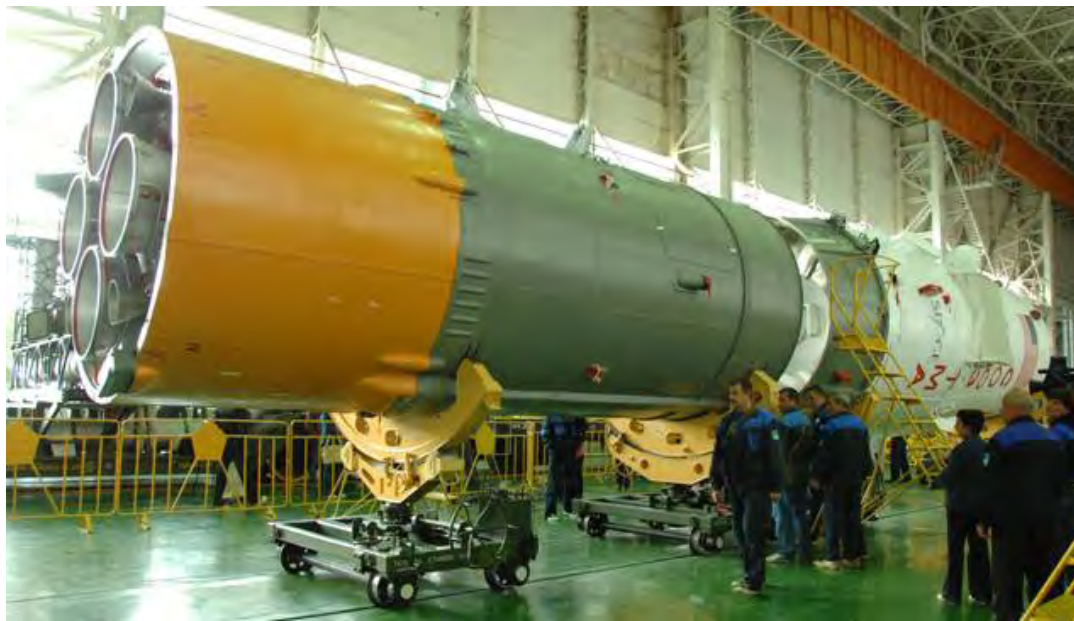
図2.1.8-4 第3段ロケットとソユーズ宇宙船を収納したペイロードシュラウドの結合作業 (RSCエネルギー社)
