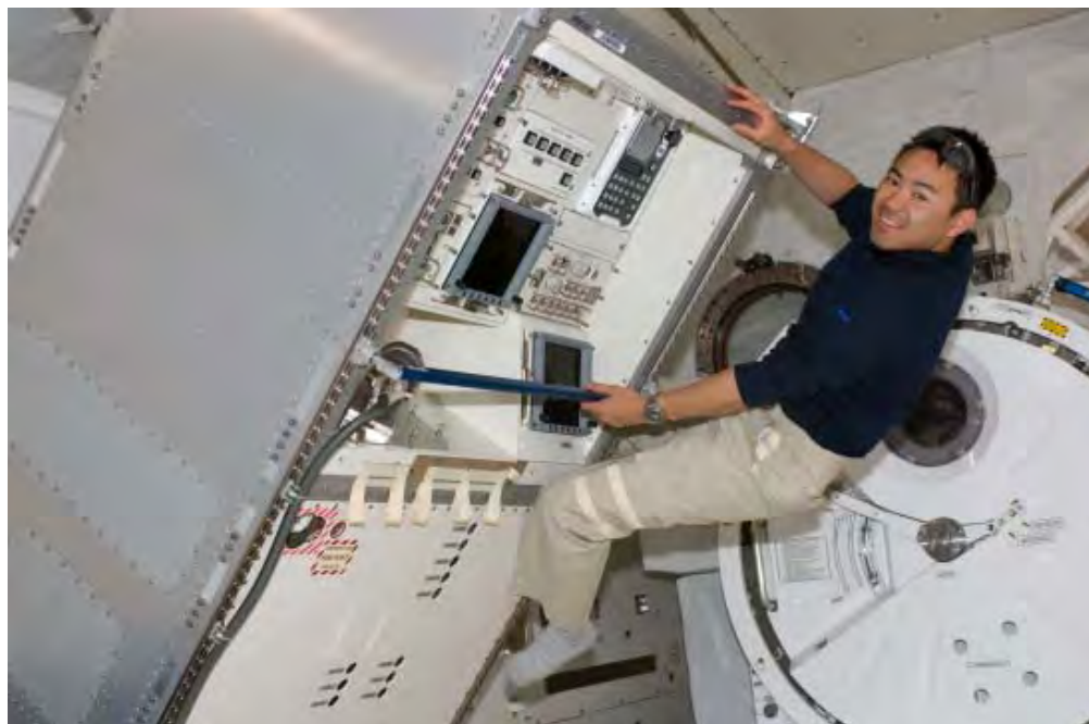
図1.3-7 ロボットアーム操作用のJEMRMSラックを移設する様子 (NASA)
