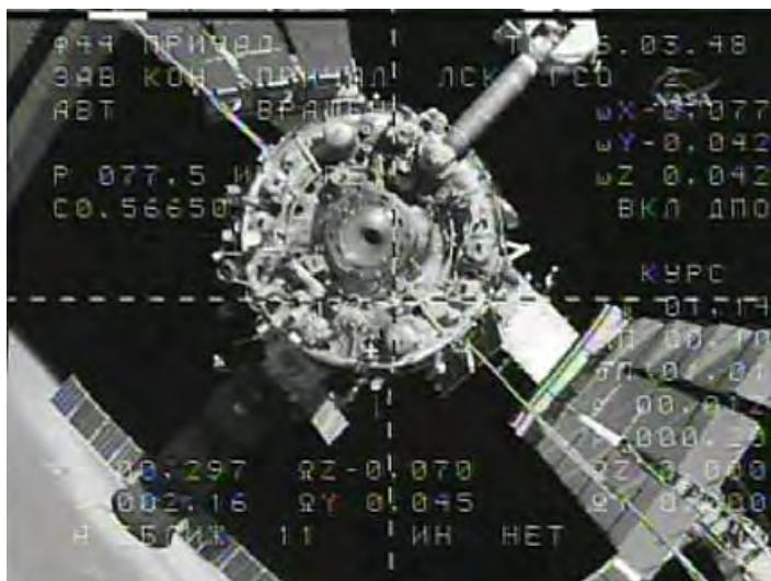
図2.1.6-1 ドッキング時の映像(カメラ映像にKursからのデータを重ねて表示) (接近速度、ISSとの距離、姿勢の変化、時刻などを表示。中心線がドッキングポートの中心からずれるのは、そこにドッキングターゲットがあるためであり異常ではありません)
