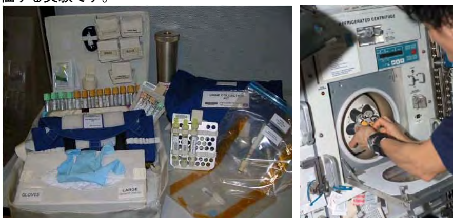
図1.4.1.2-3 Nutrition実験で使う採尿、採血キット(左)と、医学試料を扱えるISSの冷蔵遠心分離器(右) (NASA)
