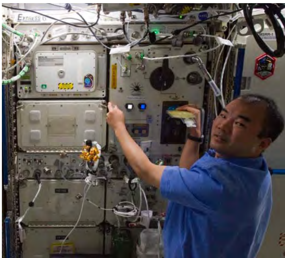
図3.3.2-4 飲料水供給装置を使う野口宇宙飛行士 (上はロシアの機器、下は米国の機器)
