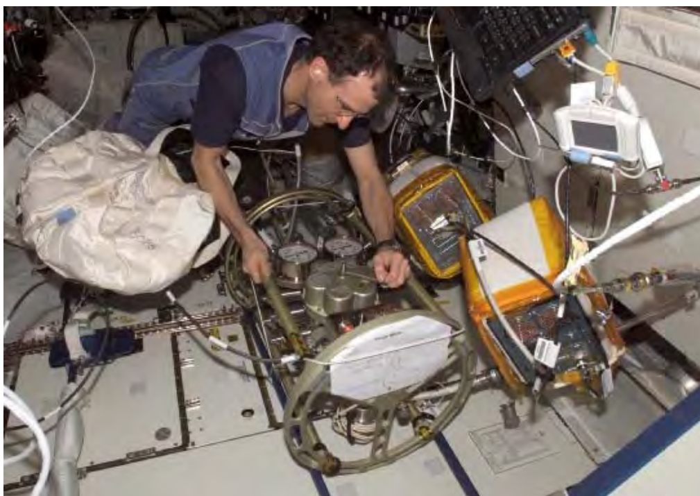
図3.3.4-8 デスティニー内での熱制御系の冷却水の補充作業
