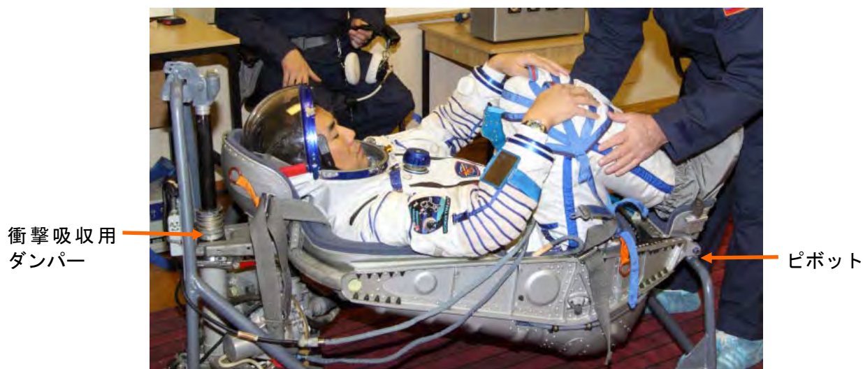
図2.1.6-8 ソユーズ宇宙船の座席シートと搭乗姿勢 (NASA)
