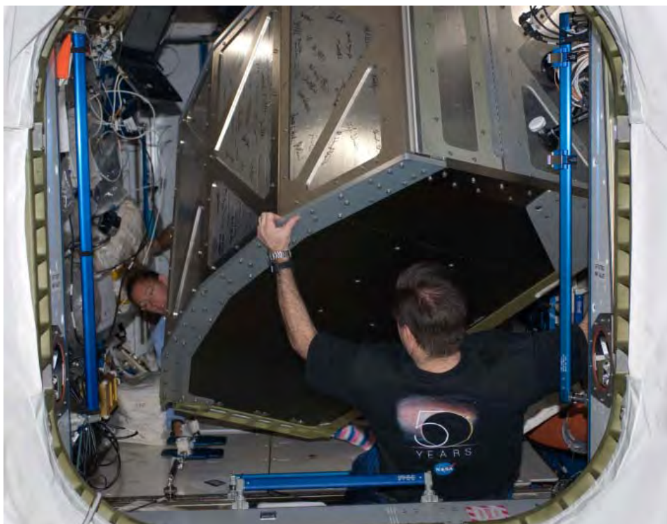
図3.3.4-14 狭いCBMハッチ部を通すラックの移動作業
