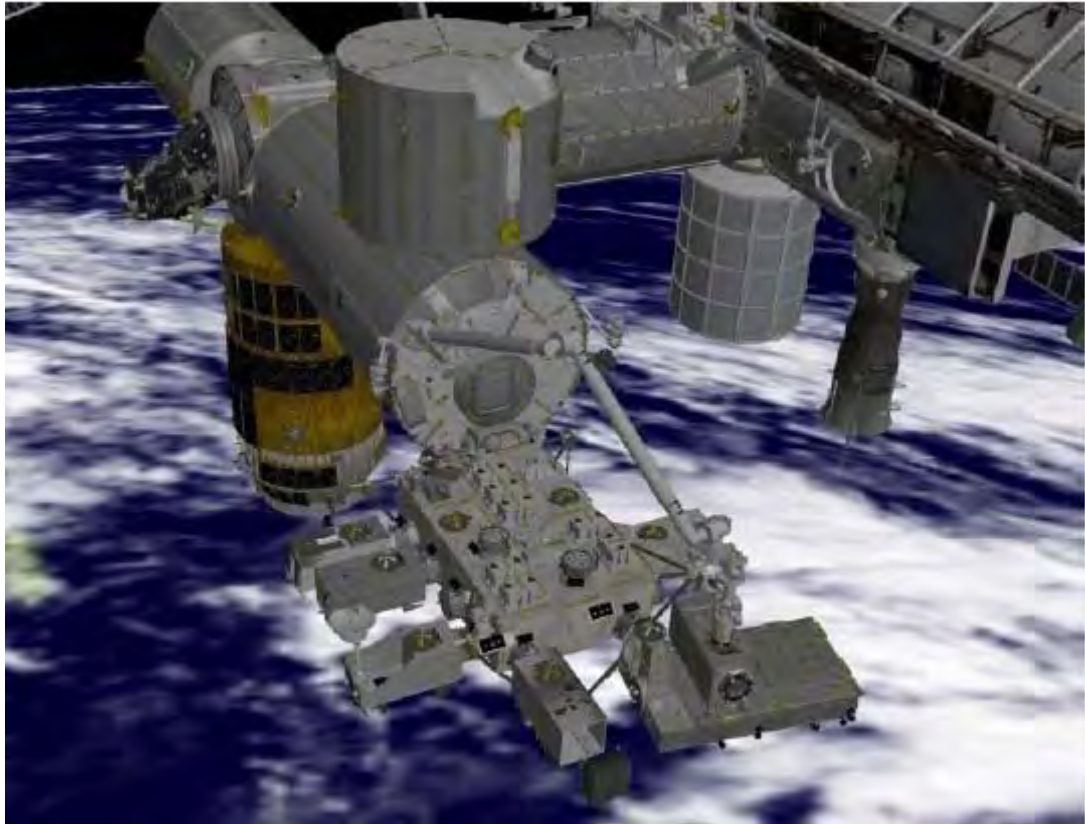
図1.4.1.1-33 JEMRMSを使ってMCEを移動するイメージ
