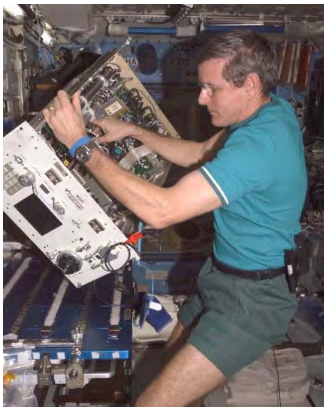
図3.3.4-7 故障した装置(揮発性有機物分析器(VOA))の修理
