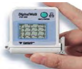
図1.4.1.1-17 心電計測に使うホルター心電計
