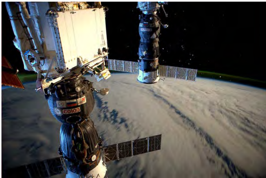
図2.1.7-7 MRM1にドッキングしたソユーズ宇宙船(29S) (ESA/NASA) 後方はプログレスM-12M(46P)補給船
