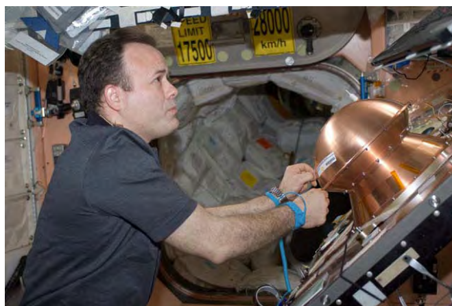
図1.4.1.1-29 REBR (ATV-2への設置前準備の様子。REBRは銅製の容器内に収納して壁に固定(銅製の容器は熱で溶けてREBRが放出されます)。
