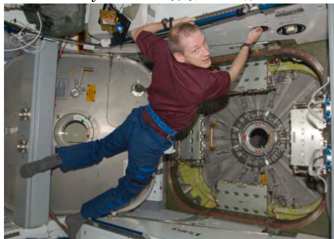
図1.4.4-6 共通結合機構(CBM)の2枚のハッチ(ISS側のハッチを開けた状態)
