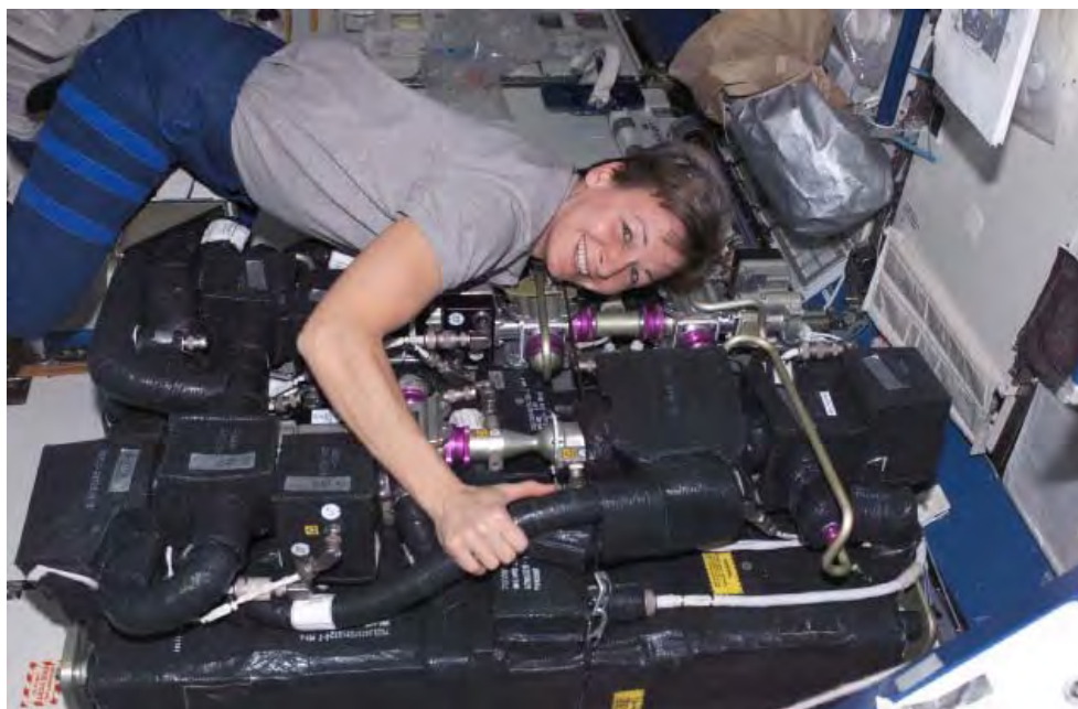
図3.3.4-3 米国の二酸化炭素除去装置(CDRA)の修理 (デスティニー内)
