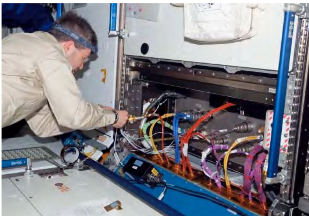
図3.3.4-12 ハーモニーの電力・通信配線のトラブルシューティング (故障箇所の究明)
