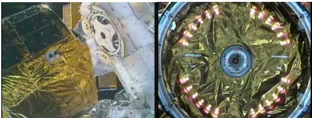
図1.4.4-5 HTV「こうのとり」到着時の共通結合機構の位置調整作業 (右は、ハーモニーの窓に位置決め用に設置するCBCS (Centerline Berthing Camera System)から撮影した映像)
