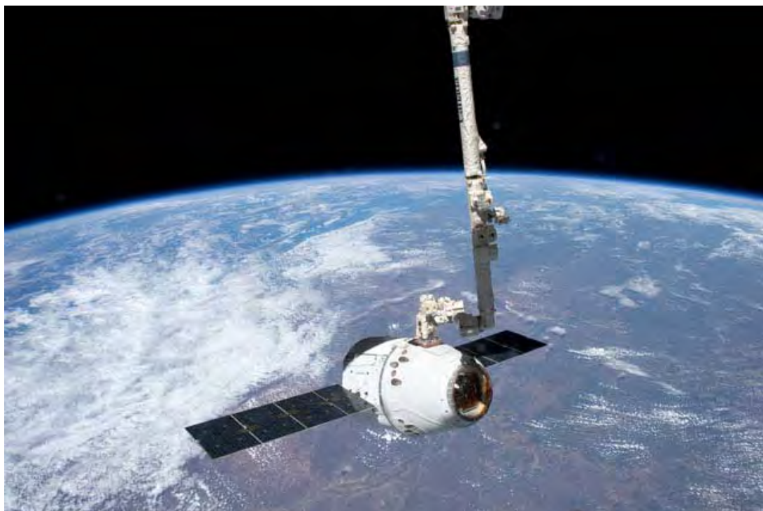
図1.4.4-2 ロボットアームで把持されたSpace X社のドラゴン補給船(C2+)(NASA)
