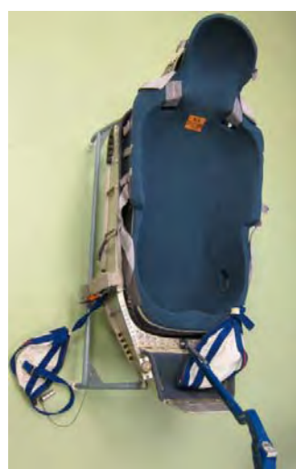
図2.1.6-9 (左)シートライナーを石膏で型とりする様子 (ESA) (右)座席にシートライナーを装着した状態(カナダ人宇宙飛行士Chris HadfieldのTwitterより)
