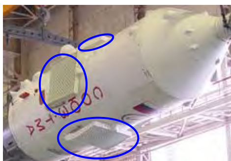
図2.1.6-6 フェアリング上の空力安定フィン (青丸内:メッシュ状で、緊急時には90度下側へ展開)
