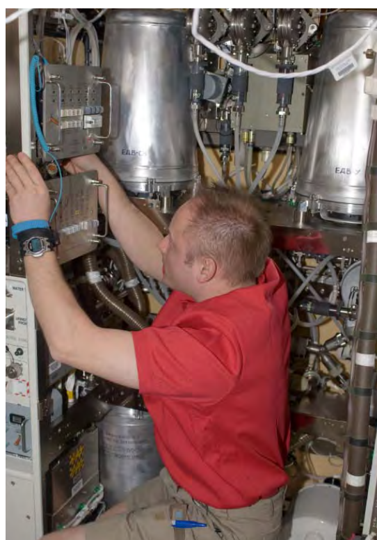
図3.3.4-6 米国のトイレ(WHC)の内部機器の組立作業
