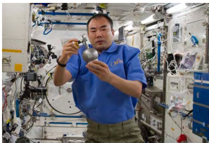
図3.3.3-7 ISS内での空気サンプルの採取作業(回収して地上で分析)
