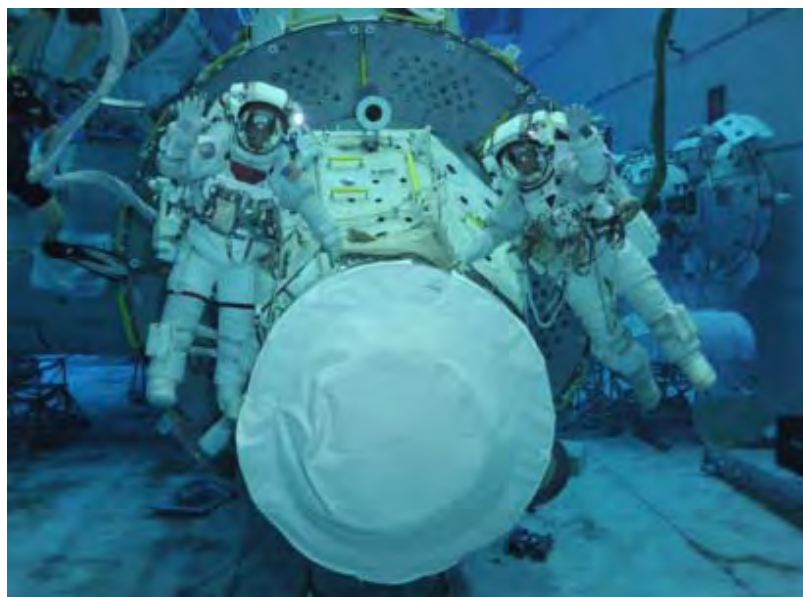
図1.4.3-3 PMA正面に設置する断熱カバー(水中訓練時の写真) (NASA)
