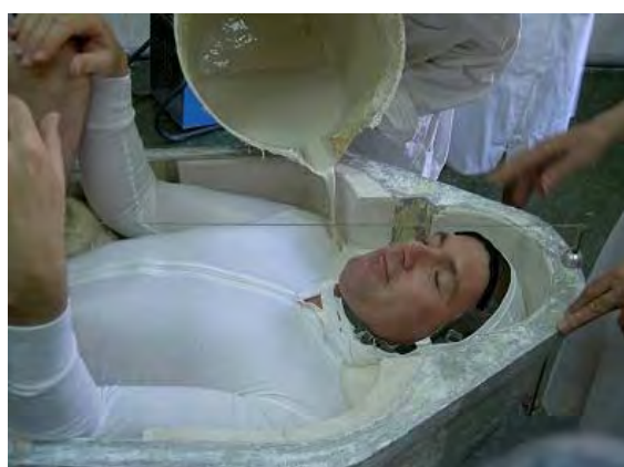
図2.1.6-9 (左)シートライナーを石膏で型とりする様子 (ESA) (右)座席にシートライナーを装着した状態(カナダ人宇宙飛行士Chris HadfieldのTwitterより)
