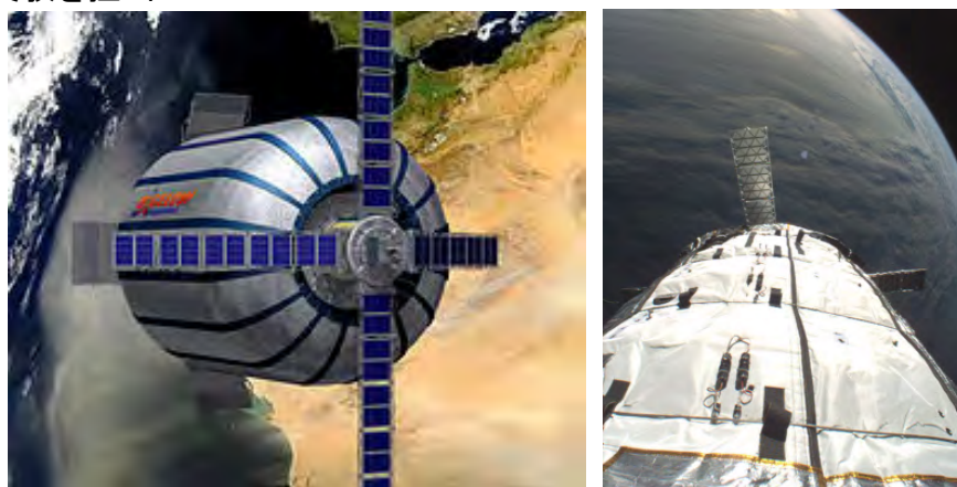
図1.4.1.1-45 (3/3) インフレーターブル実験の海外事例 右: ビゲローエアロスペース社の Genesis-I の軌道上写真 [ジェネシス I 2006年7月12日打上げ、ジェネシス II 2007年6月28日打上げ] この試験機を元に大型化した与圧モジュールを2014年に打上げ、宇宙ホテルにする計画
