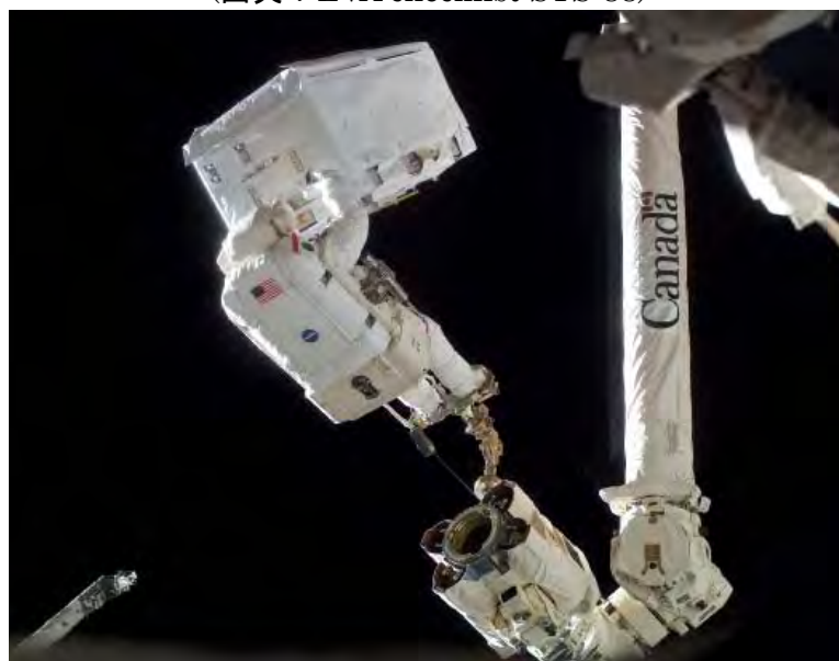
図4.2-22 SSRMSの先端に取り付けたAPFRに足を固定し、交換用の機器を運搬・移動するクルー (STS-122) (NASA)
