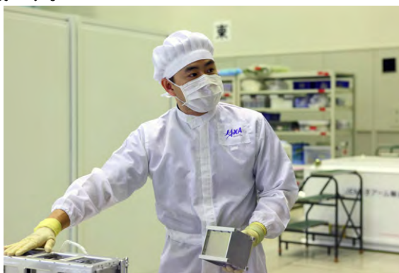
図1.4.1.1-24 CubeSat(星出宇宙飛行士が手に持っているのが1UサイズのCubeSat)
