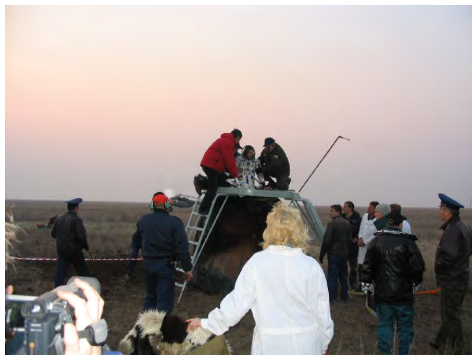
図2.1.7-16 ソユーズ宇宙船から搭乗クルーを引き出している様子 (カプセルが横倒しにならなかったときは、このように梯子を使って引き上げる)
