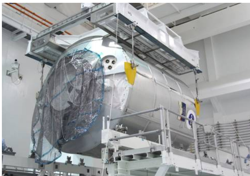
図1.7-2 スペースシャトル搭載前のMPLM(参考) (NASA KSC宇宙ステーション組立施設(SSPF))
