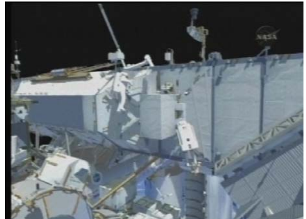
S1トラスへ新しいATAの取付け（イメージ）
