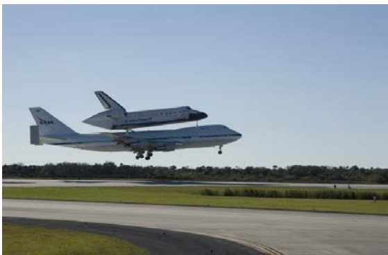
シャトル輸送機で運搬されるエンデバー号のオービタ（STS-126ミッション終了後）*
