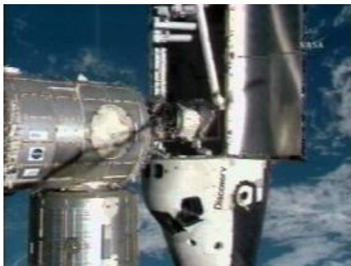
図2.2.2-4 ODSのドッキング機構とISSのPMA-2が接触したところ (この後、ODS伸展リングを引き込む)
