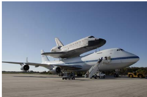
シャトル輸送機で運搬されるエンデバー号のオービタ（STS-126ミッション終了後）*
