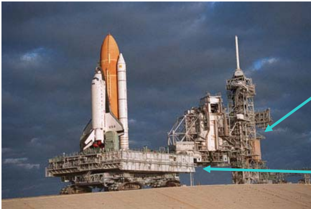
クローラー・トランスポーターによる射点への移動
