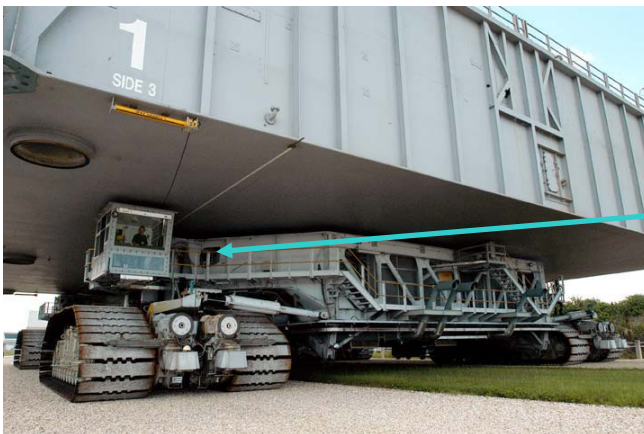
クローラー・トランスポーターによる射点への移動
