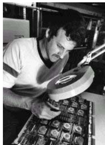
クラスタ CPU ボードを修理している フィールドサービスエンジニア
