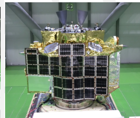
フライトモデルのシステム試験
