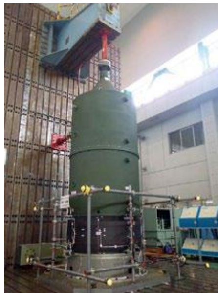
第3段モータケース(右上) と強度試験の様子
