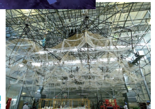
「きく8号」搭載用アンテナの展開試験
