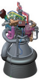
新規開発する液体酸素と液体水素を用いた大型ロケットエンジン(LE-9)
