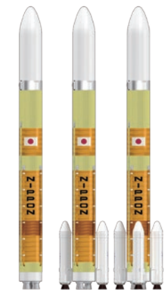
H3ロケットの第1段エンジンLE-9は2基または3基から、また、固体ロケットブースタSRB-3は、なし(左)・2本使用(中央)・4本使用(右)から選べる
