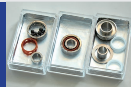
長寿命化された転がり軸受(中央)を構成する部品: 左ケース:外輪・セラミックス製の玉・保持器・内輪 右ケース:多孔質体(白色、ポリエチレン製)と間座
