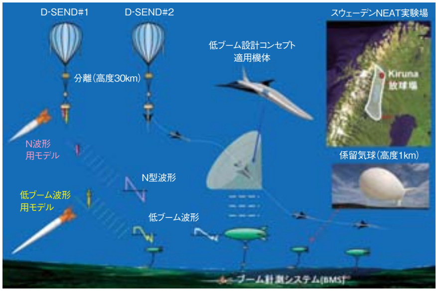
D-SENDプロジェクトは、D-SEND#1とD-SEND#2の2段階の落下試験から構成される。両試験とも、気球を使って約30km上空まで供試体運び、気球から切り離して落下させて超音速まで加速し、その時発生するソニックブームを地上のブーム計測システムにより計測。D-SEND#1では単純な形の軸対称の供試体を真下に落下させ、D-SEND#2では航空機の形状をした供試体を、ブーム計測システムの上空を通過するように誘導・制御する
